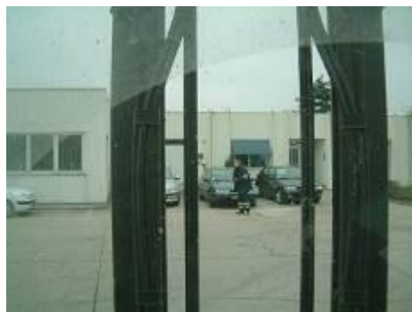
Rysunek 12: Przykład ograniczenia widoczności przez maszt FLT
