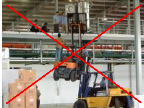
Rysunek 14. Przykład niewłaściwego użycia FLT jako podest roboczy
