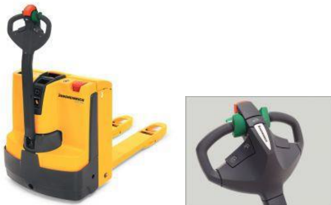
Rysunek 2. Typowy wózek paletowy i przyrządy sterujące
