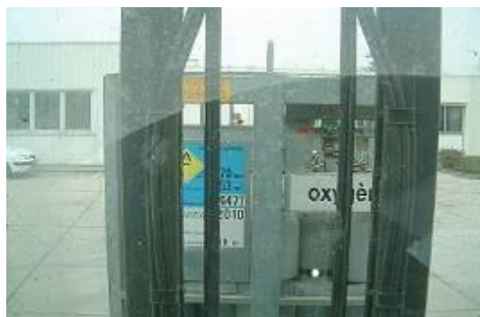
Rysunek 13: Przykład ograniczenia widoczności podczas przewożenia wiązek butli
